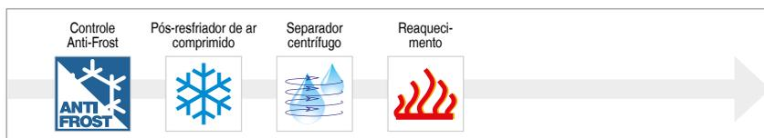
Ar comprimido seco, reaquecido a um mín. de 20°C, para trabalhar em temperaturas abaixo de zero e com linhas de ar comprimido mais longas
