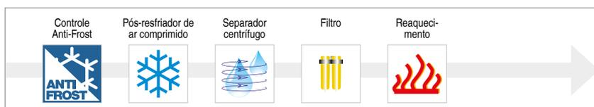
Ar comprimido seco, reaquecido a um mín. de 20°C, livre de partículas contaminantes e tecnicamente isento de óleo, conforme os regulamentos aplicáveis \*)
