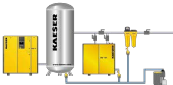
Druckluft-Aufbereitung (Filter, Kondensat-Aufbereitung, Adsorptionstrockner, Aktivkohleadsorber)
